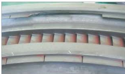
Nozzle Box 손상 (Spill Strip)
