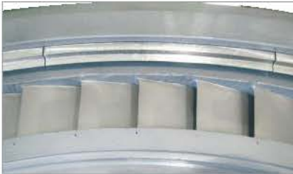
Spill Strip 조립
