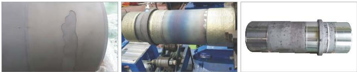
Snout Pipe 손상
