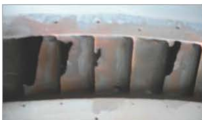
Nozzle Box 손상 (Partition)
